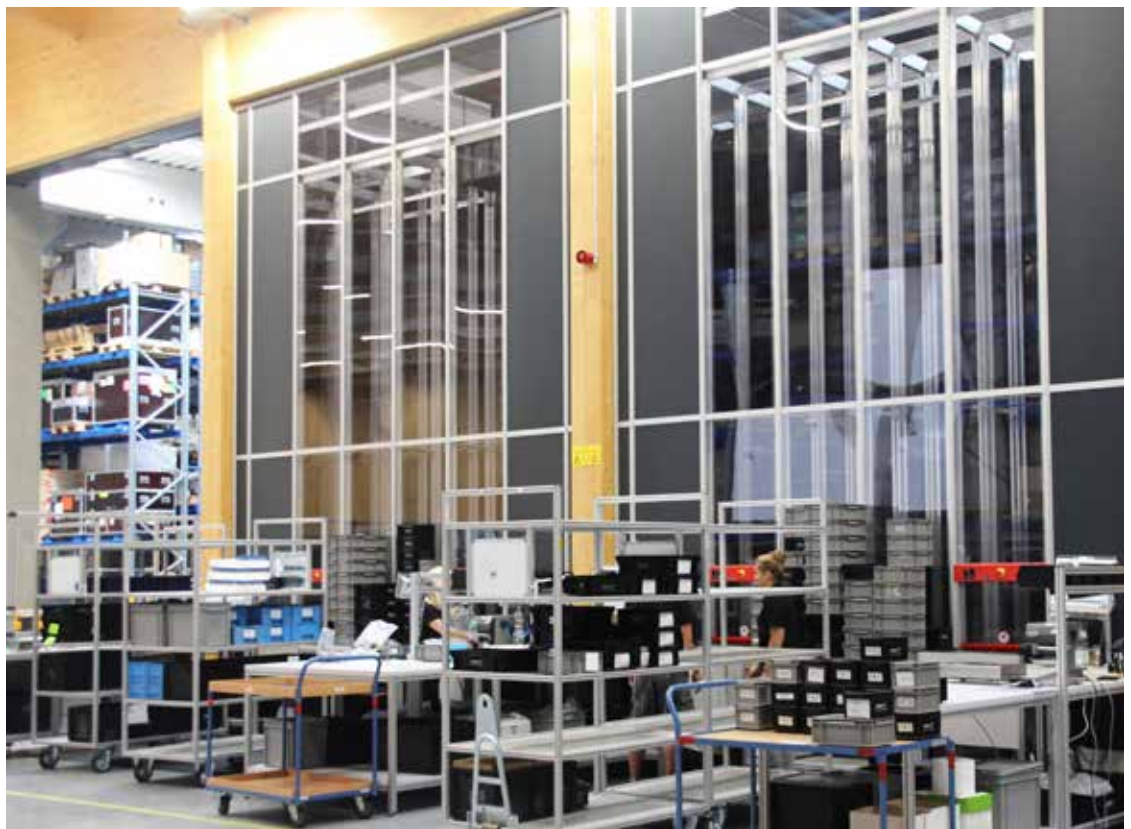
Das AutoStore-Kompaktlager des Sensorikherstellers elobau.
